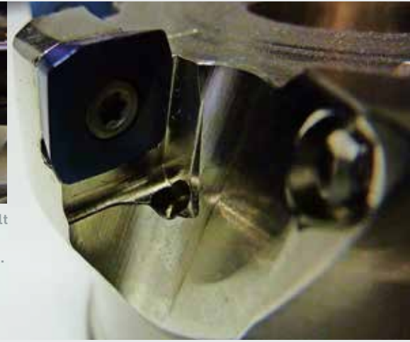
Mit den Planfräsern SX, SE45 und 60 geht der weiche Schnitt auch bei hohen Vorschüben. Damit ist größte Zerspanung bei wenig Leistungsaufnahme möglich.
