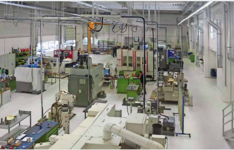
Erste Einblicke in die zwei neuen Fertigungshallen von Avantec: links Fräseerei, Vorfertigung, Werkzeugbau; rechts Schleiferei – samt 7.000-Liter-Ölzentralanlage. Messtechnisch ist Avantec gut aufgestellt mit diversen Zeiss-Messmaschinen und einer die Werkzeugschneiden dokumentierenden Venturion 600 von Zoller. Für gutes Klima sorgt die aufwändige Wärmerückgewinnungsanlage.
