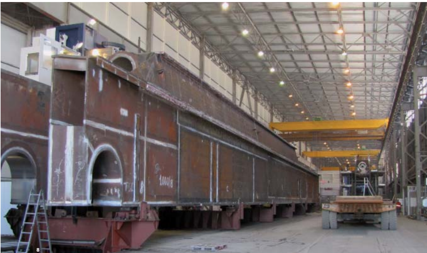
8 Eines der Werkstücke bei Cimolai in voller Größe: Jeder der insgesamt 16 Träger ist 64 Meter lang, 6 Meter hoch und wiegt 800 Tonnen.
